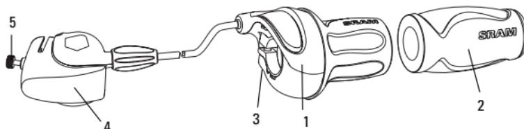
**Handgrepen hebben een axiale beveiligingsfunctie en moeten zo gemonteerd zijn dat ze niet van het stuur kunnen afglijden.**
