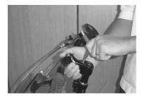
**STEP 5:** Loosen the stem angle adjuster bolt.
