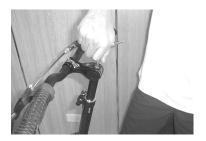
**STEP 1:** Loosen the stem steerer bolt.
