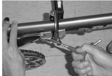
**Schritt 2:** Um den Hebel strammer einzustellen, muessen Sie den Gewindebolzen im Uhrzeigersinn tiefer in die fixierte Mutter eindrehen. Um den Hebel etwas weicher einzustellen drehen Sie den Gewindebolzen gegen den Uhrzeigersinn. Bitte den Gewindebolzen nur in kleinen Schritten von ca. 1/8 Umdrehung verstellen - nach jeder Verstellung ausprobieren, ob die neue Schliesskraft ausreicht (ca. 5-6 kg).
