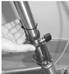
**Schritt 3b:** Drehen Sie den Sicherheitshaken zurueck, damit der Faltmechanismus fuer die Lenksaeule betaetigt werden kann.
