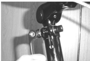
**Schritt 4:** Schließen Sie den Schnellspanner an der hoehenverstellbaren Lenksaeule.
