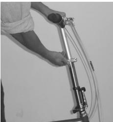
**Schritt 2b:** Drehen Sie den Vorbau in die Faltstellung.
