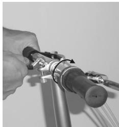
**Schritt 8c:** Oeffnen Sie den Schnellspanner des Vorbaues und drehen Sie den Lenker bis zu Anschlag.
