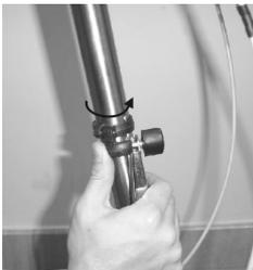
**Schritt 7c:** Die Lenksaeule verriegeln Sie mit dem Verschlusshebel bis dieser einschnappt. Auch hier sichern Sie diesen Verschluss mit dem Sicherungshaken, indem Sie diesen in die entsprechende Position drehen.
