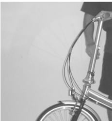
**Schritt 2a:** Drehen Sie die Lenksaeule in die Faltstellung. Wenn Sie einen winkelverstellbaren Vorbau haben, beachten Sie die Hinweise auf Seite 28.
