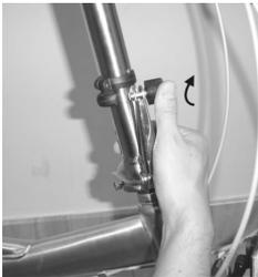
**Schritt 7b:** Die Lenksaeule verriegeln Sie mit dem Verschlusshebel bis dieser einschnappt.
