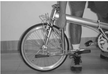
**Schritt 5:** Schwenken Sie nun die Lenksaeule nach unten, d.h. der Lenker ist nun neben der unteren Haelfte des Vorderrades. Stellen Sie sicher, dass das Vorderrad parallel zum Rahmen steht (der Lenker sollte unmittelbar unterhalb der Vorderrad-Achse stehen).
