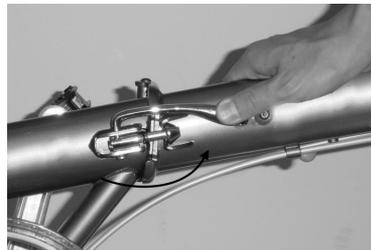
**Schritt 4:** Jetzt schliessen Sie den Rahmenverschluss, indem Sie den Schliesshebel zum Rahmen hin druecken. Um den Verschluss zu schliessen, muss eine Kraft von ca. 6 kg aufgewendet werden.
