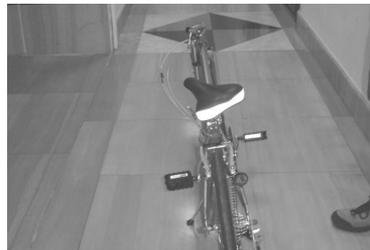
**Schritt 6:** Öffnen Sie den Schnellverschluss am Rahmen-Sattelrohr. Schieben Sie das Sattelrohr nun bis zum Anschlag ein. Drehen Sie dabei den Sattel um ca. 45 Grad nach links. Schliessen Sie den Schnellverschluss.
