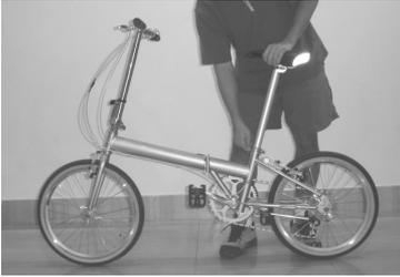
**Schritt 10:** Oeffnen Sie den Schnellspanner am Sattelrohr und richten Sie den Sattel in der gewünschten Hoehe aus. Achten Sie darauf, dass dabei das Sattelrohr nur bis zur eingravierten max. Markierung herausgezogen wird. Anschliessend wieder den Schnellspanner schliessen.
