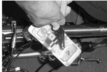
**Schritt 2:** Um die Schliesskraft zu erhoehen, drehen Sie an der Stellschraube gegen den Uhrzeigersinn. Um die Kraft zu reduzieren, drehen Sie im Uhrzeigersinn. Bitte in Schritten von 1/16 Umdrehung.
