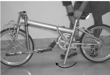
**Schritt 7:** Drehen Sie die Pedalarms so, dass das linke Pedal waagrecht nach vorne zeigt.
