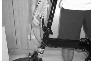
**Schritt 8:** Öffnen Sie die Verriegelung durch Ziehen nach außen.
