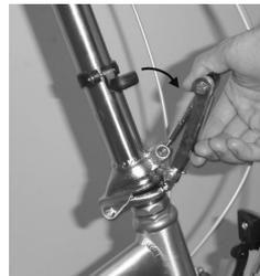
**Schritt 4b:** Nun koennen Sie den Hebel nach unten ziehen und entriegeln somit die Lenksaeule.
