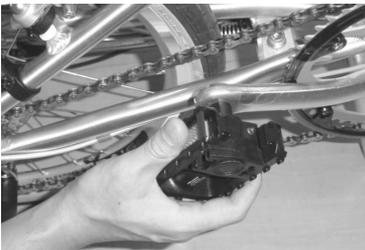
**Schritt 12:** Falten Sie das/die Pedal(e), indem Sie es nach innen drücken (zum Rahmen hin) und dann abkippen. Achtung: Finger immer ausserhalb des Faltmechanismus halten. Verletzungsgefahr!
