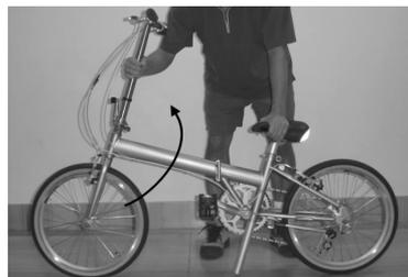
**Schritt 6:** Schwenken Sie nun die Lenksaeule nach oben in die Vertikale.
