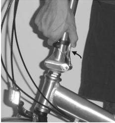
**Schritt 7a:** Die Lenksaeule verriegeln Sie mit dem Verschlusshebel bis dieser einschnappt.
