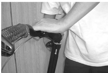
**Schritt 3:** Schieben Sie den Vorbau in die hoehenverstellbare Lenksaeule.
