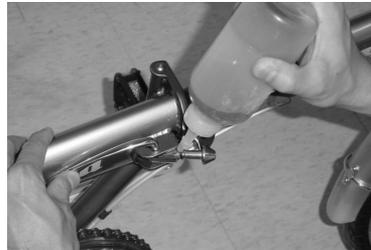
**Schritt 3:** Um sicher zu sein, dass sich die Position der Stellschrauben nicht veraendert, koennen Sie die Gewinde mit einem Tropfen Schraubensicherung (Loctite) fixieren.
