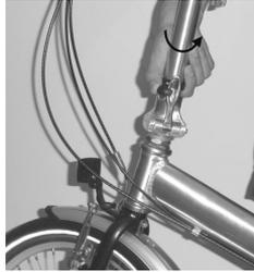
**Schritt 8a:** Auch hier sichern Sie diesen Verschluss mit dem Sicherungshaken, indem Sie diesen in die entsprechende Position drehen.
