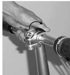
**Schritt 9c:** Schliessen Sie den Schnellspanner.
