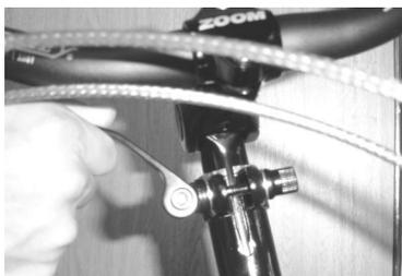
**Schritt 2:** Oeffnen Sie den Schnellspanner des verstellbaren Vorbaues.
