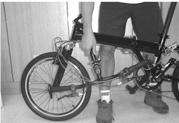
**Schritt 9:** Bringen Sie Vorbau und Lenker in "Faltposition" (nach unten klappen - gegen Vorderrad und Rahmen).
