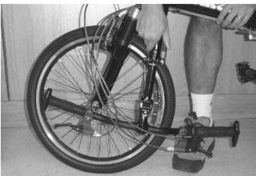
**Schritt 11:** Schnellspanner an der Lenksäule wieder schließen.
