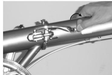
**Schritt 8:** Entriegeln Sie den Sicherungshaken am Rahmenverschluss.
