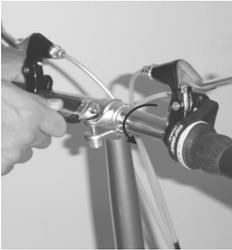
**Schritt 2c:** Öffnen Sie den Schnellspanner des Lenkers und drehen den Lenker, so dass die Bremshebel gerade nach oben zeigen.
