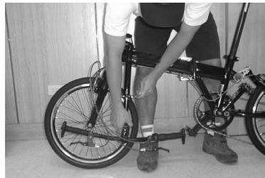
**Schritt 10:** Lösen Sie den Schnellspanner an der Lenksäule und stellen Sie die Höhe so ein, daß sich der Lenker unterhalb des Gabelendes befindet.
