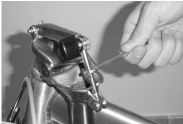
**Schritt 2:** Um die Schliesskraft zu erhoehen, drehen Sie an der Stellschraube gegen den Uhrzeigersinn. Um die Kraft zu reduzieren, drehen Sie im Uhrzeigersinn. Die Stellschraube nur in kleinen Schritten von ca. 1/8 Umdrehung verstellen.
