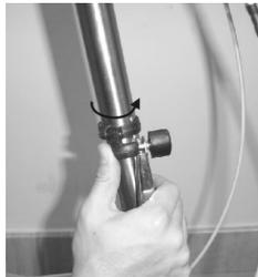
**Schritt 8b:** Auch hier sichern Sie diesen Verschluss mit dem Sicherungshaken, indem Sie diesen in die entsprechende Position drehen.
