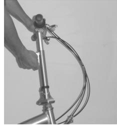
**Schritt 9a:** Bringen Sie die hoehenverstellbare Lenksaeule in die gewuenschte Hoehe. Sollte das Faltrad mit einem verstellbaren Lenkervorbau ausgeruestet sein, stellen Sie auch diesen in die gewuenschte Position.
