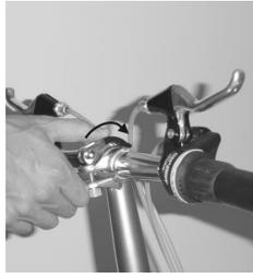
**Schritt 3c:** Schliessen Sie den Schnellspanner.
