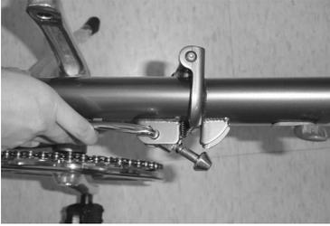
**Schritt 9:** Öffnen Sie den Rahmenverschluss-Hebel.
