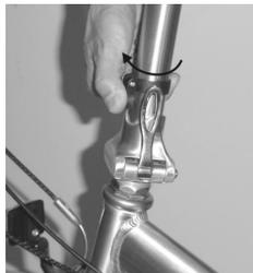
**Schritt 3a:** Drehen Sie den Sicherheitshaken zurueck, damit der Faltmechanismus fuer die Lenksaeule betaetigt werden kann.
