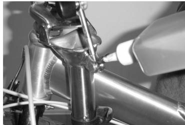
**Schritt 5:** Oelen Sie den Verschlussmechanismus regelmassig.
