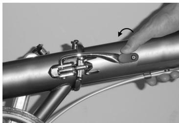
**Schritt 5:** Sichern Sie den Rahmenverschluss mit dem kleinen Sicherungshaken aus Kunststoff.
