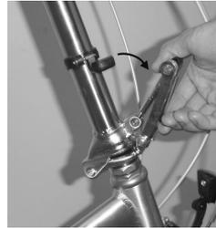
**Schritt 4c:** Drehen Sie den Sicherheitshaken zurück, damit der Faltmechanismus fuer die Lenksaeule betaetigt werden kann. Nun koennen Sie den Hebel nach unten ziehen und entriegeln somit die Lenksaeule.
