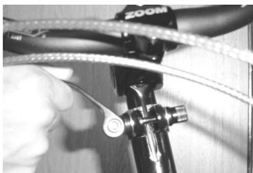
**Schritt 2:** Oeffnen Sie den Schnellspanner am verstellbaren Vorbau.
