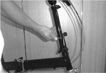
**Schritt 7:** Öffnen Sie den Sicherungshaken der Steuerrohrverriegelung.
