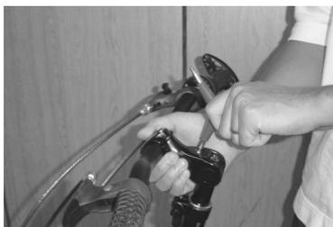
**Schritt 5:** Loesen Sie die Schraube fuer die Winkelverstellung am Vorbau.
