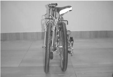
**Schritt 11:** Wenn Ihr Fahrrad mit dem "Magnetix Arretiersystem" ausgestattet ist, treffen die beiden Magnete aufeinander. Wenn nicht überprüfen Sie, ob das Fahrrad richtig zusammengeklappt wurde.
