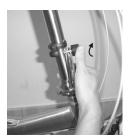
**Schritt 6b:** Die Lenksaeule verriegeln Sie mit dem Verschlusshebel bis dieser einschnappt.
