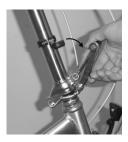
Schritt 4c: Drehen Sie den Sicherheitshaken zurueck, damit der Faltmechanismus fuer die Lenksaeule betaetigt werden kann. Nun koennen Sie den Hebel nach unten ziehen und entriegeln somit die Lenksaeule.
