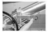
Schritt 4: Sichern Sie den Rahmenverschluss mit dem kleinen Sicherungshaken aus Kunststoff. (Hinweis: Der Sicherungshebel fuer den Rahmenverschluss befindet sich in einer leicht von dem Bild abweichenden Position.)
