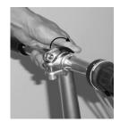
**Schritt 8c:** Schliessen Sie den Schnellspanner.
