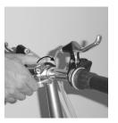
**Schritt 3c:** Schliessen Sie den Schnellspanner.
