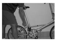
Schritt 9: Oeffnen Sie den Schnellspanner am Sattelrohr und richten Sie den Sattel in der gewuenschten Hoehe aus. Achten Sie darauf, dass dabei das Sattelrohr nur bis zur eingravierten max. Markierung herausgezogen wird. Anschliessend wieder den Schnellspanner schliessen.
