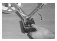
Schritt 10A: Montage der Pedale: Bei der Montage bitte beachten, dass Sie ein rechtes Pedal (R) und ein linkes (L) haben. Das Rechte muss im Uhrzeigersinn eingeschraubt werden, das Linke gegen den Uhrzeigersinn.
