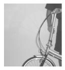
**Schritt 2a:** Drehen Sie die Lenksaeule in die Faltstellung.
