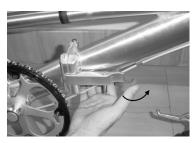
Schritt 8: Entriegeln Sie den Sicherungshaken am Rahmenverschluss. (Hinweis: Der Sicherungshebel fuer den Rahmenverschluss befindet sich in einer leicht von dem Bild abweichenden Position.)
