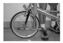
Schritt 5: Schwenken Sie nun die Lenksaeule nach unten, d.h. der Lenker ist nun neben der unteren Haelfte des Vorderrades. Stellen Sie sicher, dass das Vorderrad parallel zum Rahmen steht (der Lenker sollte unmittelbar unterhalb der Vorderrad-Achse stehen).
