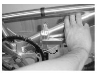
Schritt 3: Jetzt schliessen Sie den Rahmenverschluss, indem Sie den Schliesshebel zum Rahmen hin druecken. Um den Verschluss zu schliessen, muss eine Kraft von ca. 6 kg aufgewendet werden.
