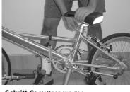
Schritt 6: Oeffnen Sie den Schnellverschluss am Rahmen-Sattelrohr. Schieben Sie das Sattelrohr nun bis zum Anschlag ein. Drehen Sie dabei den Sattel um ca. 45 Grad nach links. Schliessen Sie den Schnellverschluss.
