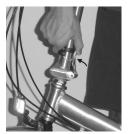
**Schritt 6a:** Die Lenksaeule verriegeln Sie mit dem Verschlusshebel bis dieser einschnappt.
