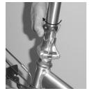
Schritt 3a: Drehen Sie den Sicherheitshaken zurueck, damit der Faltmechanismus fuer die Lenksaeule betaetigt werden kann
