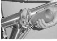
Schritt 3: Schmieren Sie den Verschlussmechanismus regelmaessig.
