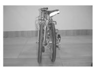
Schritt 11: Wenn Ihr Fahrrad mit dem "Magnetix Arretiersystem" ausgestattet ist, treffen die beiden Magnete (einer an der linken Seite der Gabel und einer am hinteren Ausfallende) aufeinander. Wenn nicht ueberprueffen Sie, ob das Fahrrad richtig zusammengefaltet wurde.
