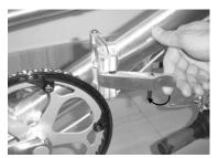
**Schritt 9:** Oeffnen Sie den Rahmenverschluss-Hebel.
