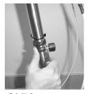
Schritt Gc: Die Lenksaeule verriegeln Sie mit dem Verschlusshebel bis dieser einschnappt. Auch hier sichern Sie den Verschluss mit dem Sicherungshaken, indem Sie diesen in die entsprechende Position drehen.
