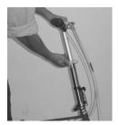
**Schritt 2b:** Drehen Sie den Vorbau in die Faltstellung.
