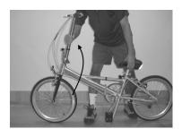
**Schritt 5:** Schwenken Sie nun die Lenksaeule nach oben in die Vertikale.
