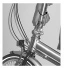
Schritt 7a: Sichern Sie den Verschluss mit dem Sicherungshaken, indem Sie diesen in die entsprechende Position drehen.
